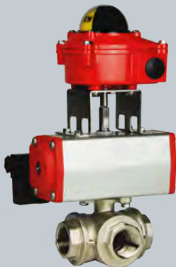
Muffen-Kugelhahn mit pneumatischem Antrieb doppelwirkend mit flexiblen Endschalterboxen mit optischer Stellungsanzeige mit 5/2-Wege Magnetventil Messing vernickelt
