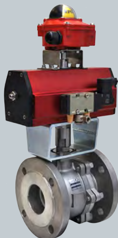
Flanschen-Kugelhahn mit vollem Durchgang mit pneumatischem Antrieb doppelwirkend mit flexiblen Endschalterboxen mit optischer Stellungsanzeige mit 5/2-Wege Magnetventil Edelstahl
